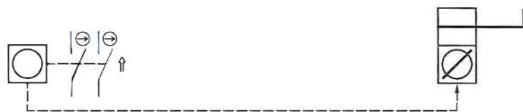
L'azionamento della chiave nella serratura provoca lo sblocco dell'accesso
