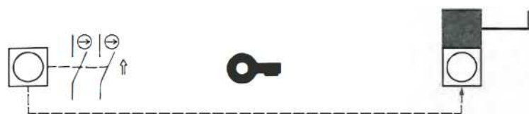
La chiave viene trasferita dall'interruttore di arresto alla serratura di accesso all'interno della zona pericolosa
