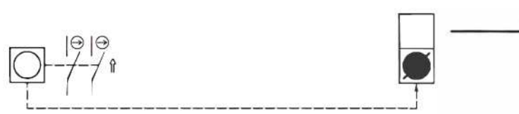
La rimozione dell'attuatore dalla serratura di accesso intrappola la chiave
