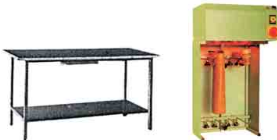
Figura 52 - Ejemplo de banco de trabajo para encolar el solaje del zapato montado y de la suela y horno reactivador del pegamento.
