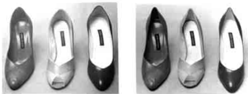
Figura 67 - Ejemplo de perfilado de cañas para zapatos de señora. A la izquierda antes del tratamiento, a la derecha después del tratamiento.
