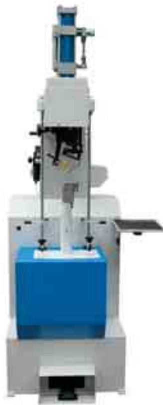
Figura 59 - Ejemplo de máquina para clavar tacones con operaciones de aguante eficaz y al mismo tiempo delicadas.
