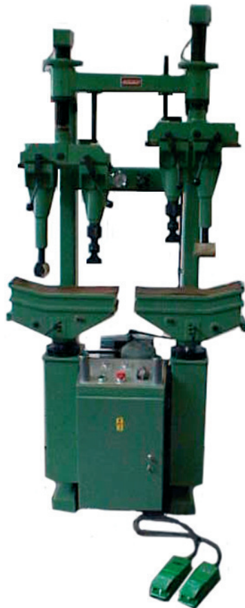
Figure 55 - Presse semelles hydrauliques à deux postes : un à secteurs lamellaires pour chaussures à talon haut, l'autre à cuvette à eau.
