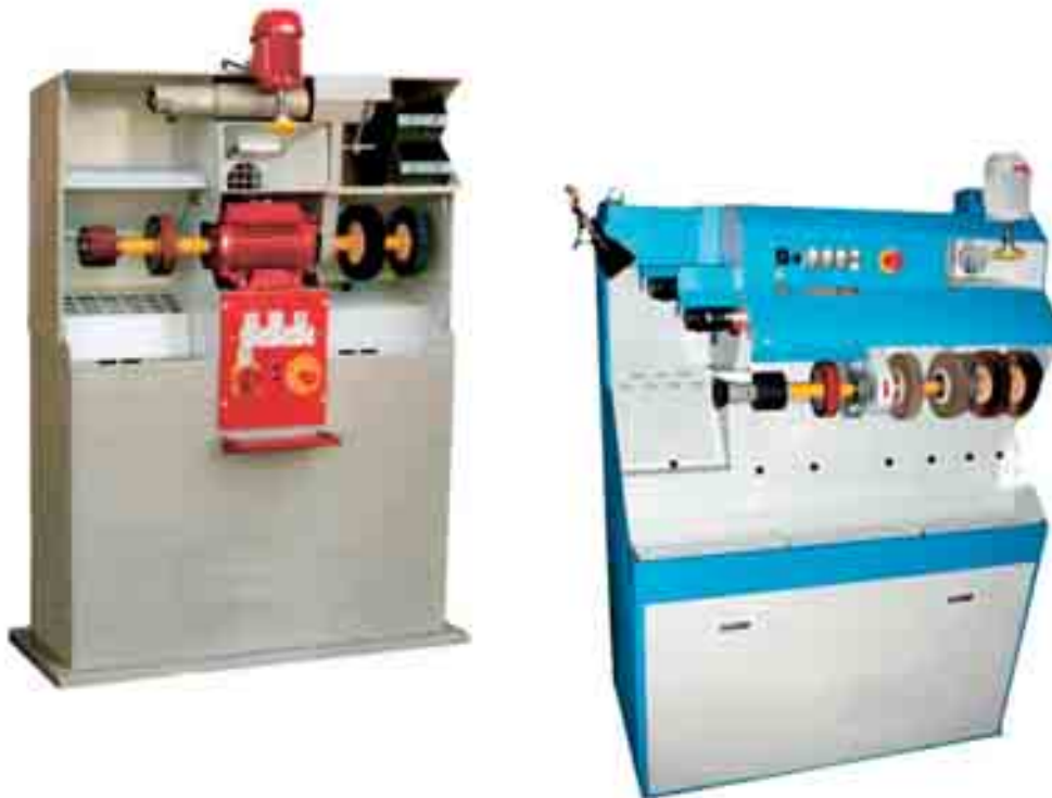
Figura 64 - Ejemplos de máquinas multifunción con varias herramientas disponibles en el mismo puesto de trabajo; él de la izquierda para microempresas; él de la derecha para pequeñas empresas.
