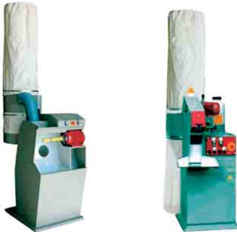
Figura 51 - Ejemplo de máquinas para esmerilar la superficie del borde montado del corte. A la izquierda, versión con papel de lija en tampón; a la derecha, versión con papel de lija en cinta.
