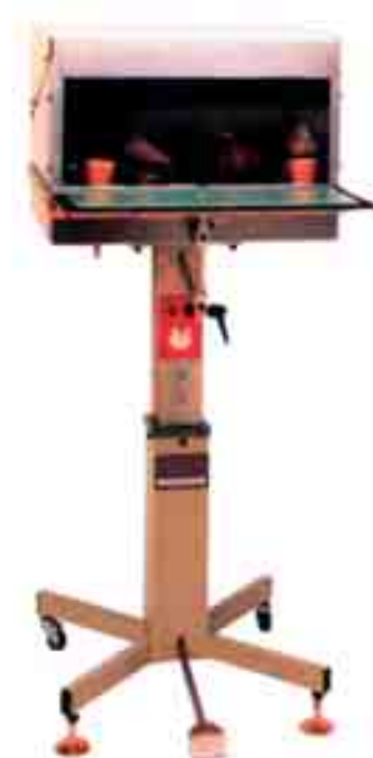
Figura 44. Esempio di apparecchiatura per umidificazione della tomaia e riattivazione di puntali e contrafforti.
