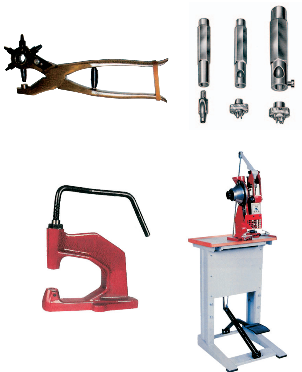
Figure 40 – En haut: autres outils manuels utilisés en jointerie. En bas: Appareils pour application de ferrets en général: totalement manuel à gauche; de première mécanisation, à droite, avec perforation de matériel et application de ferrets en même temps.
