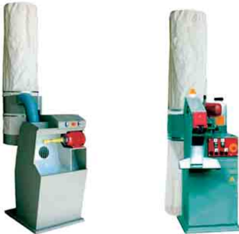
Figura 51 – Esempio di macchine per la smerigliatura della superficie del bordo montato della tomaia. A sinistra, versione con cartavetro a tampone; a destra, versione con cartavetro a nastro.
