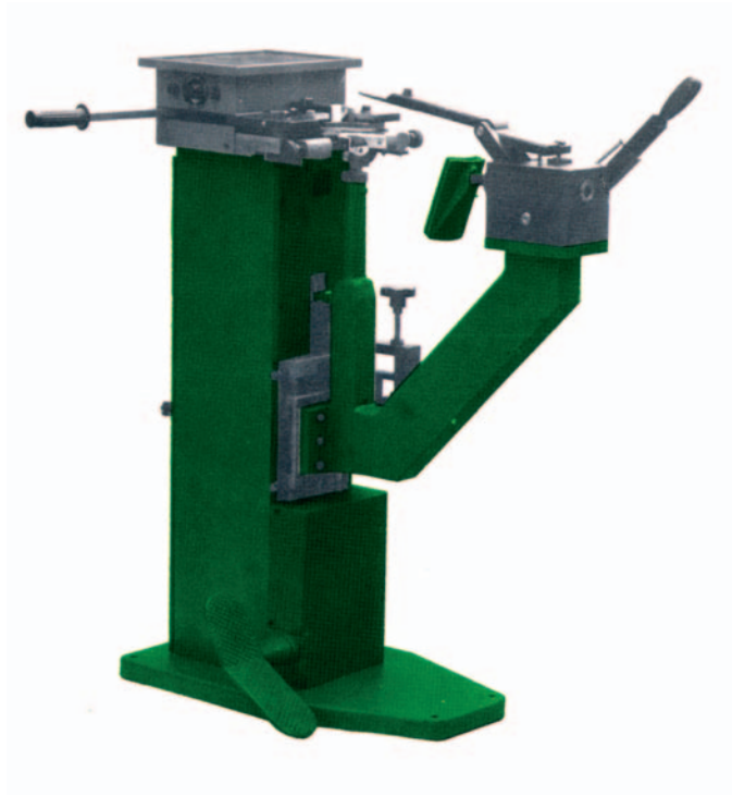
Figure 47 - Exemple de machine pour monter les bouts à action pneumatique.
