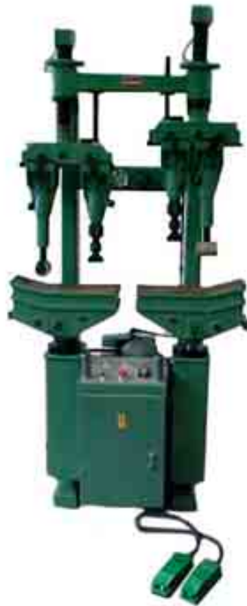
Figura 55. Prensa suelas hidráulica con dos puestos: una con sectores laminares para calzados con tacón, arriba, la otra con pileta con agua.
