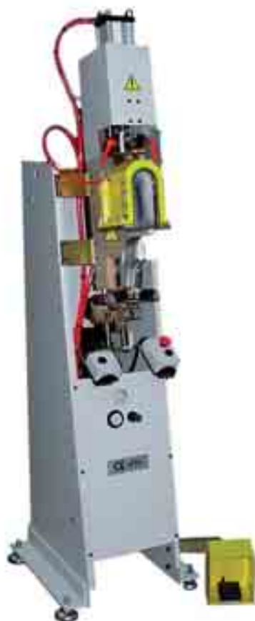
Figura 43. Esempio di macchina garbasperoni.
