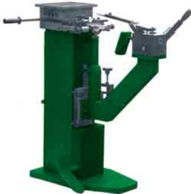
Figura 47. Esempio di montapunte con azionamento pneumatico.
