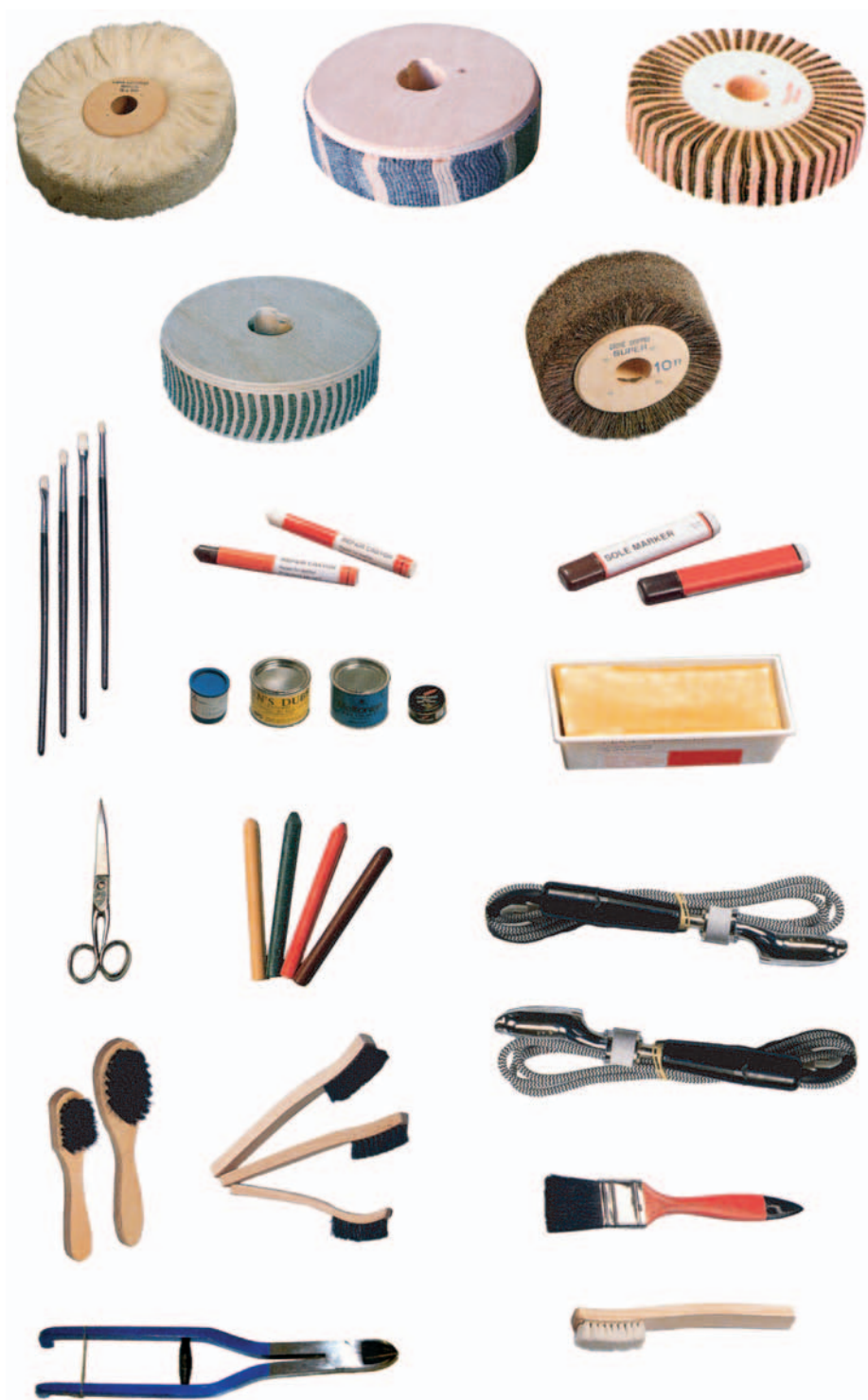
Figure 63 – Ensemble d'outils manuels présents durant le finissage.
