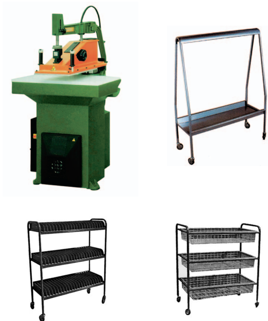
Figure 30 - En haut: exemple de presse à découper à bras et de chariot porte peaux. En bas: exemple de chariot à trois niveaux pour les emporte-pièce, à gauche; et pour les tiges à droite.
