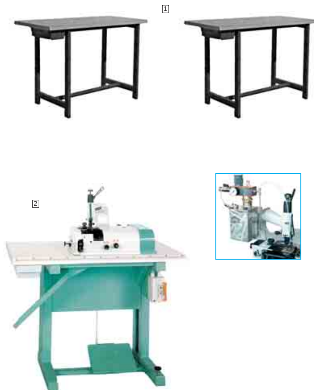
Figura 34 - Ejemplos de mesas y de máquina para operaciones de rebajado a lo largo de bordes de partes de corte.
