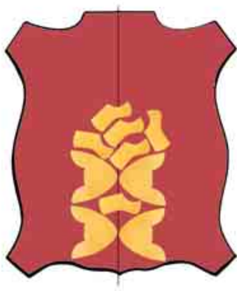
Figura 28 - Ejemplo de disposición correcta de los patrones de un modelo sobre una piel.
