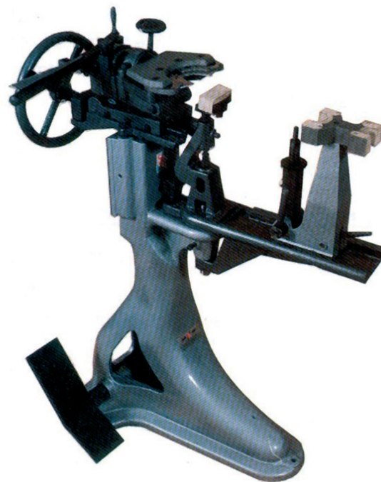
Figure 45 - Exemple de machine pour monter les bouts et pour l'emboîtement que l'on utilise à l'intérieur de structures artisanales.
