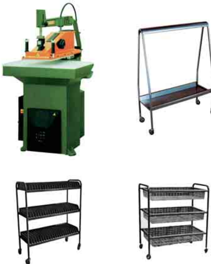
Figura 30 – In alto: esempio di fustellatrice a braccio e di carrello porta pelli. In basso: esempio di carrello a tre piani portafustelle, a sinistra; e di portatomaie a destra.
