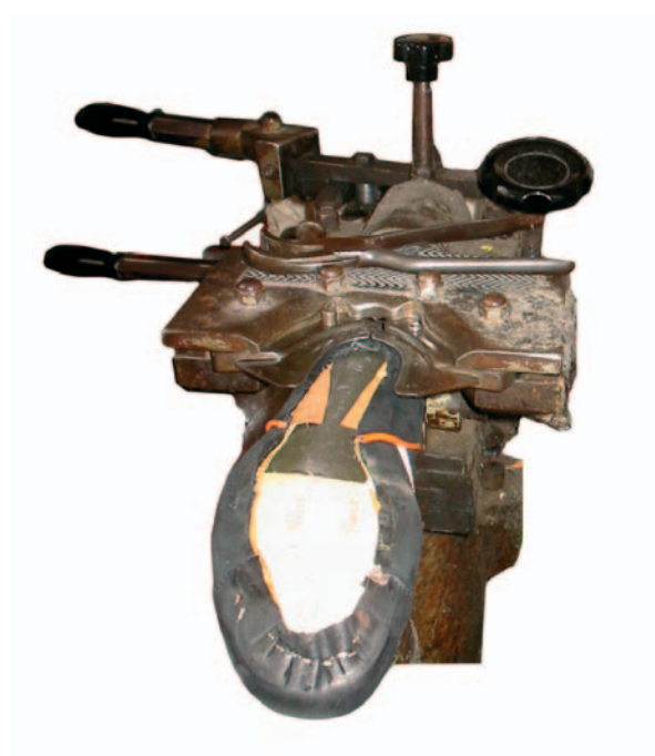
Figure 46 - Montage de l'emboîtement à machine actionné manuellement.
