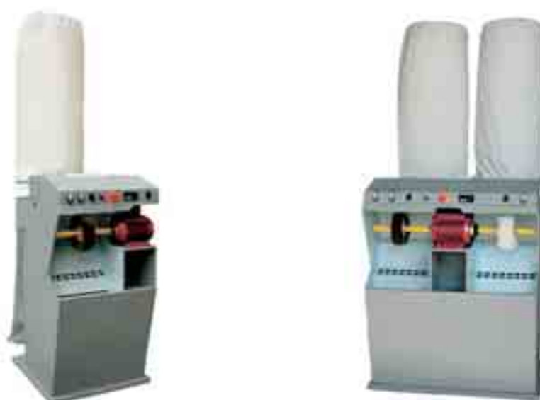
Figura 68 - Ejemplo de cepilladoras-lustradoras con un puesto de trabajo a la izquierda y con dos puestos a la derecha.
