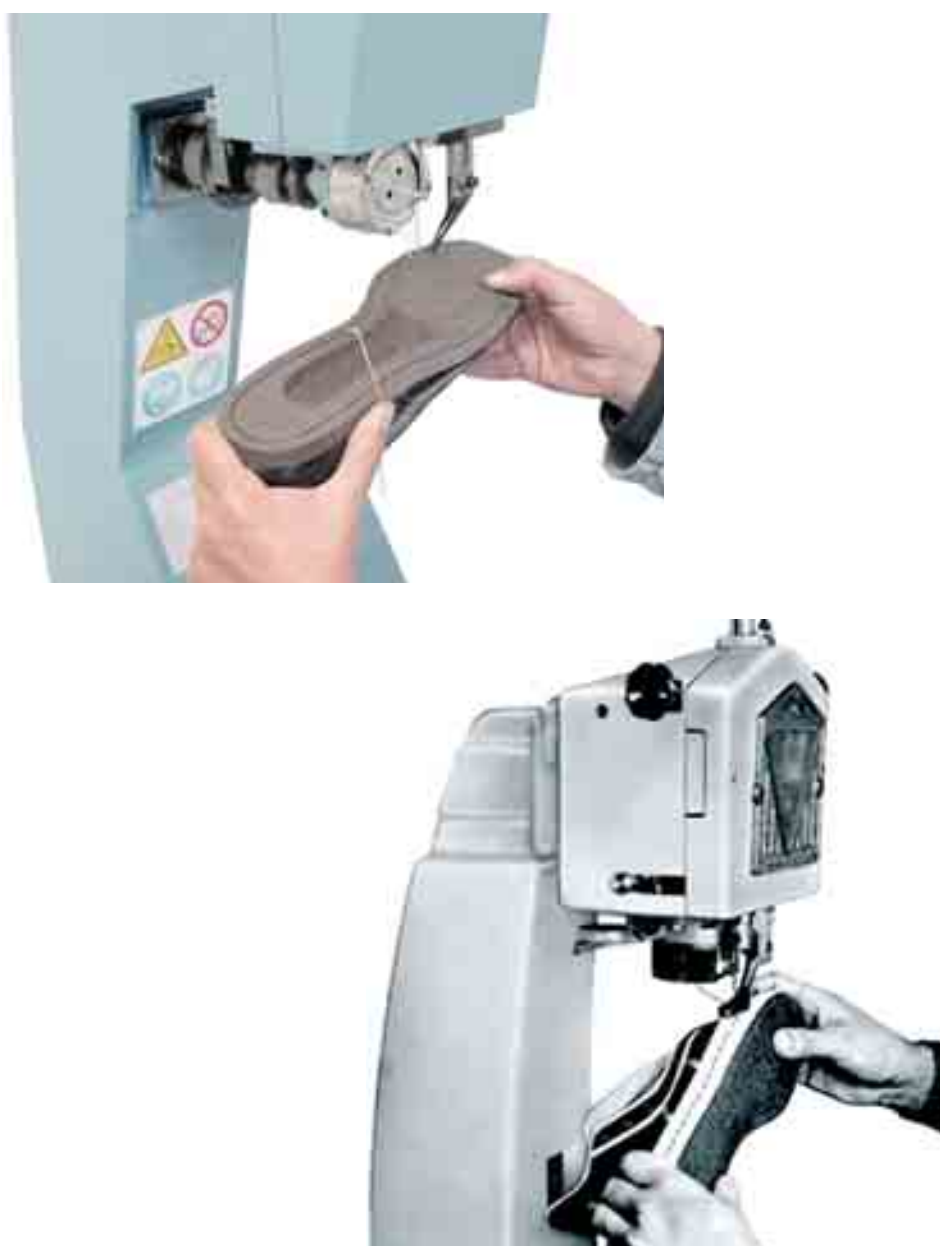
Figura 57 - Esempio di macchina per la cucitura a Blake del fondo della calzatura, nella foto a sinistra e per la cucitura laterale della suola nella foto a destra.
