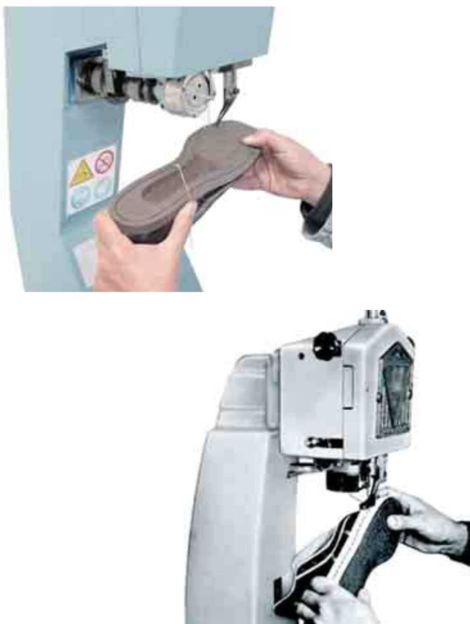
Figura 57 - Ejemplo de máquina para la costura Blake del solaje del calzado, en la foto de la izquierda y para la costura lateral de la suela en la foto de la derecha.
