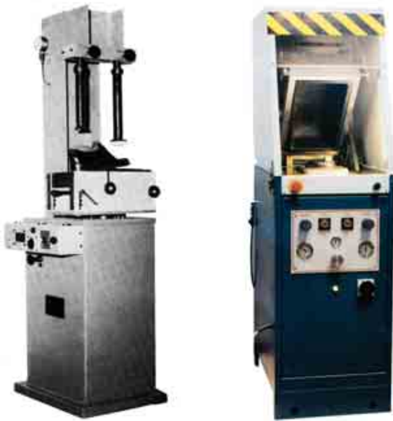
Figura 53 - Ejemplo de máquinas prensadoras de suelas con un puesto de trabajo. A la izquierda, versión hidráulica con apoyo de sectores; a la derecha, versión neumática tipo con membrana apta también para las suelas opanka.
