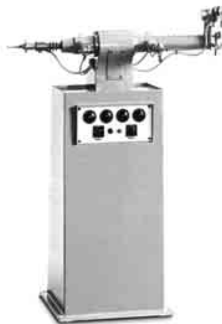
Figura 62 - Ejemplo de máquina con cuatro cabezas calentadas para operaciones múltiples de acabado del borde de la suela.
