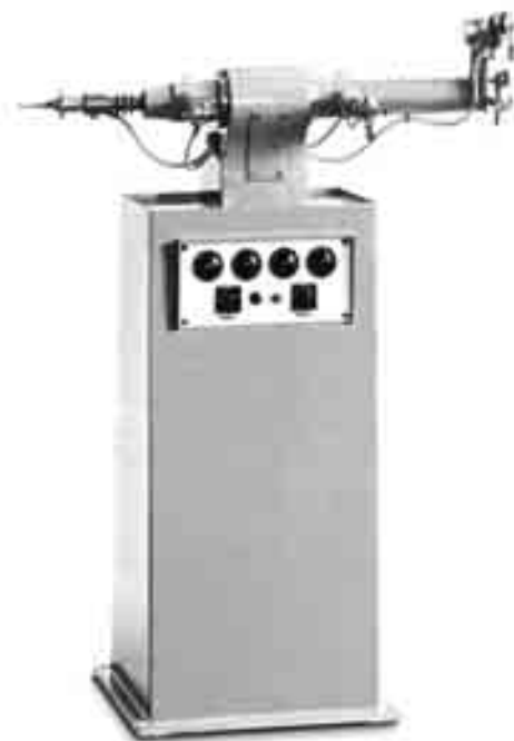
Figura 62 - Esempio di macchina dotata di quattro teste riscaldate per interventi multipli di rifinitura del bordo della suola.
