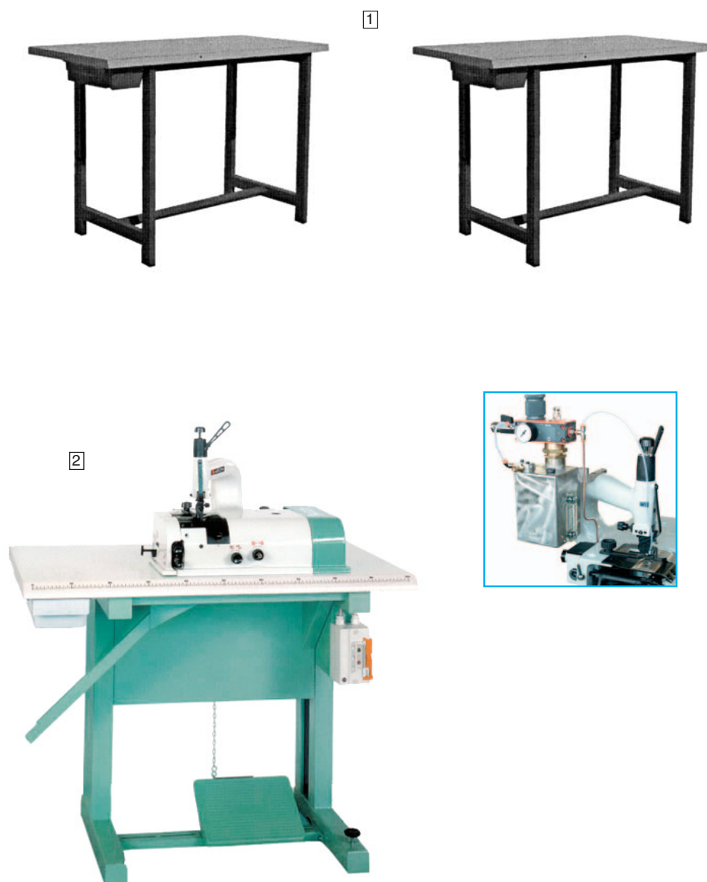
Figure 34 – Exemples de tables et de machines pour des interventions d'écharnage le long des bords et des parties de tiges.
