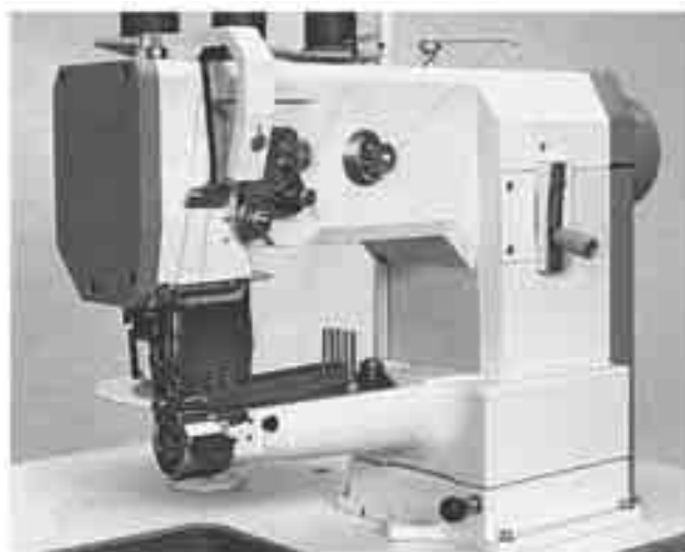
Figura 39 - Ejemplo de máquina con base de brazo equipada para operaciones de rebordeado.
