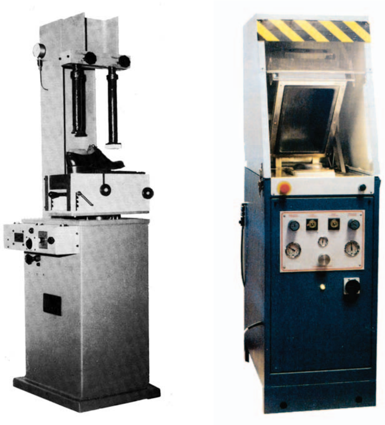
Figure 53 – Exemple de machine presse-semelle sur un poste de travail. A gauche, version oléo-dynamique avec appui à secteur; A droite, version pneumatique à membrane adaptée également pour les semelles «en boîte».
