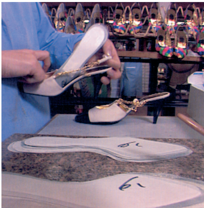
Figure 65 – Exemple d'application d'une talonnette de propreté
