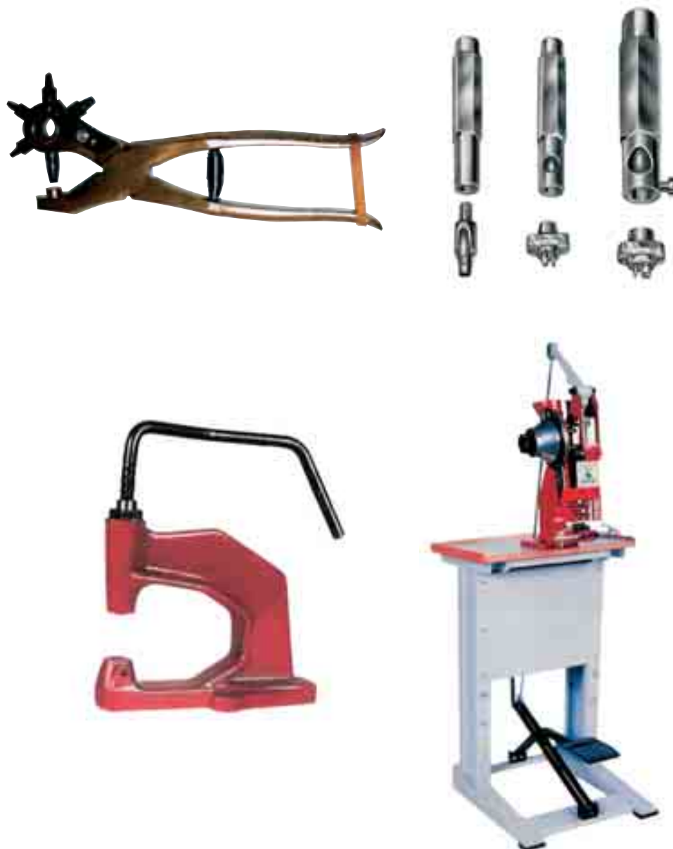
Figura 40 – In alto: altri attrezzi manuali di utilità in giunteria. In basso: Apparecchiature per applicazione di ferrosi in genere: del tutto manuale a sinistra; di prima meccanizzazione, a destra, con perforazione del materiale e applicazione del ferroso in contemporanea.
