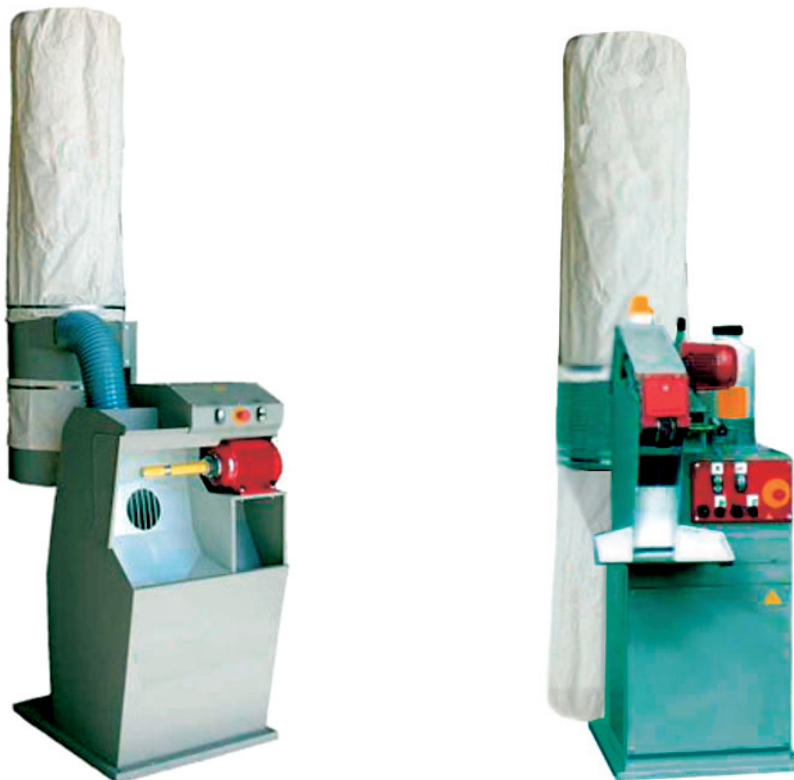
Figure 51 – Exemple de machine à verrer la surface du bord monté de la tige. A gauche, version avec papier de verre à tampon; à droite version avec papier de verre à ruban
