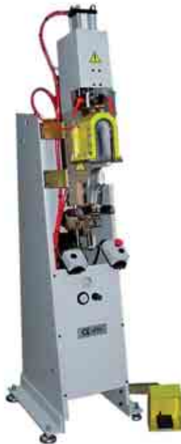
Figura 43. Ejemplo de máquina moldeadora de traseras.
