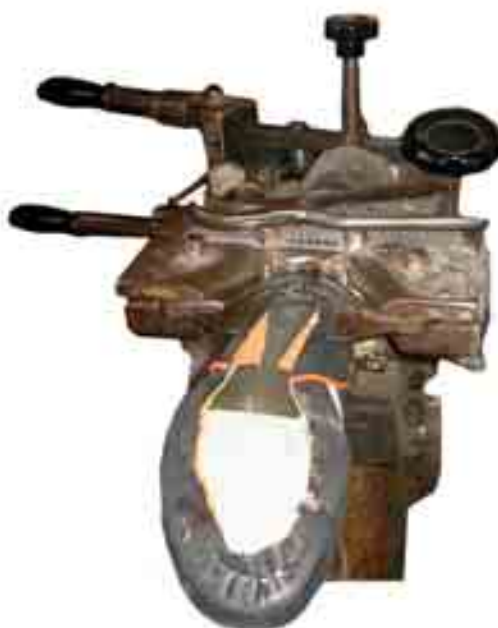
Figura 46. Montaggio della boetta a macchina azionata manualmente.
