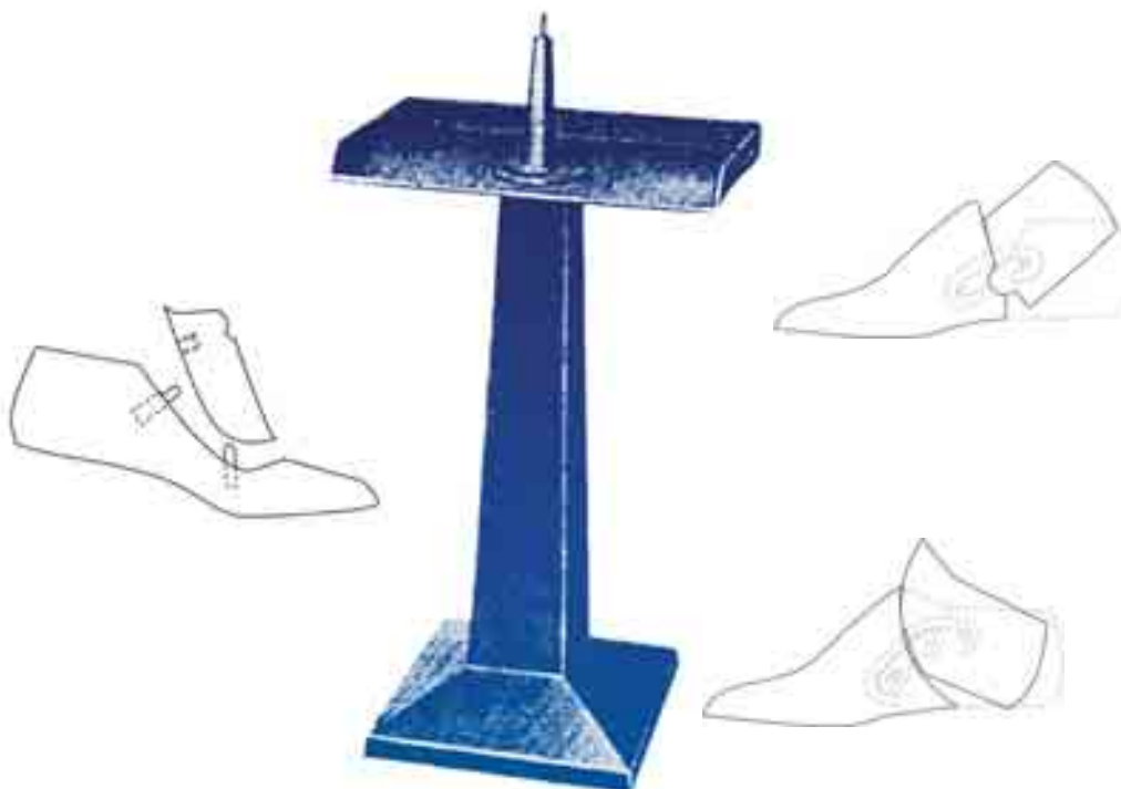
Figura 56 – Esempio di attrezzatura per il supporto della scarpa montata al momento dell'estrazione della forma e modi di predisposizione della forma prima di operare l'intervento.
