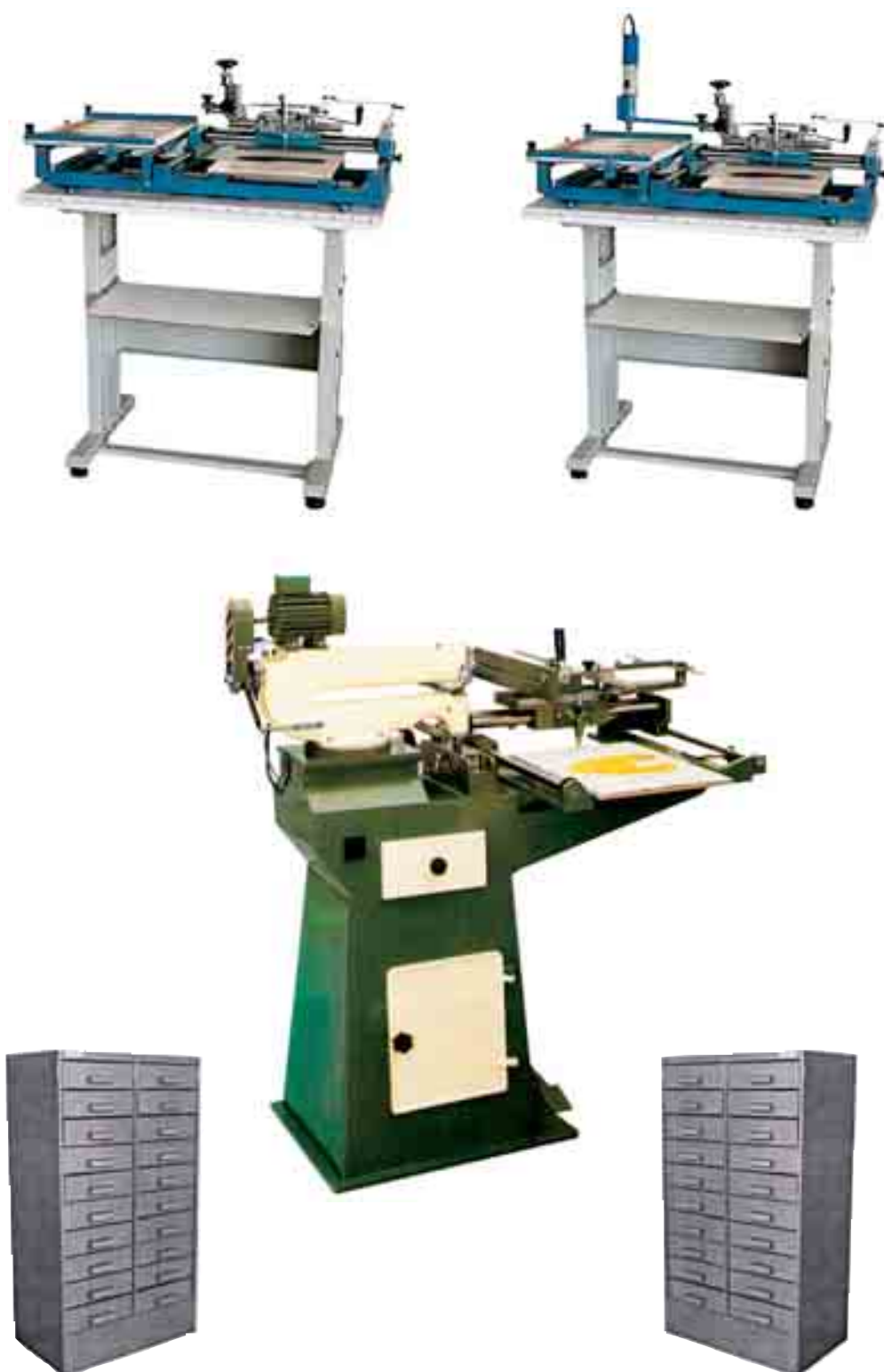
Figura 21 - Algunos ejemplos de pantógrafos y cajoneras portamodelos
