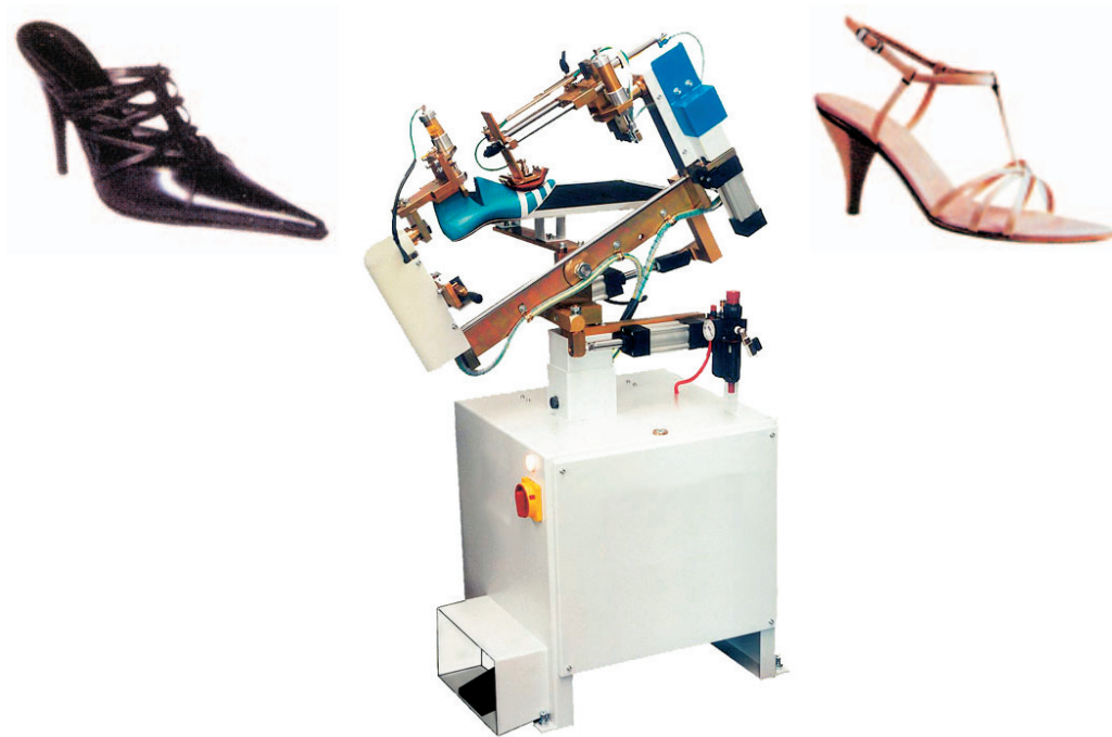
Figure 49 – Exemple de machine de nouvelle génération pour le montage assisté de sandales et de chaussures à tiges ouvertes à l'arrière.
