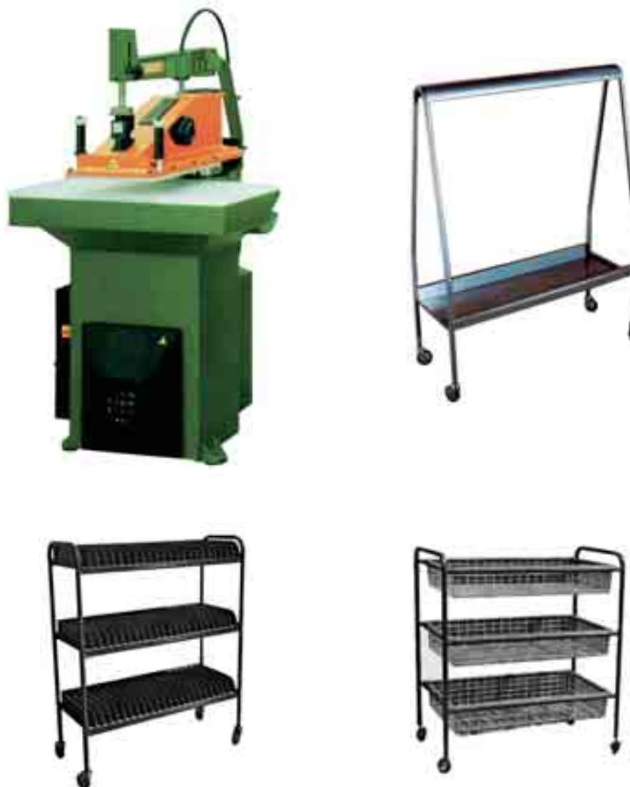
Figura 30 - Arriba: ejemplo de troqueladora con brazo y de carro portapieles. Abajo: ejemplo de carro de tres pisos portatroqueles, a la izquierda, y de portaempeines a la derecha.
