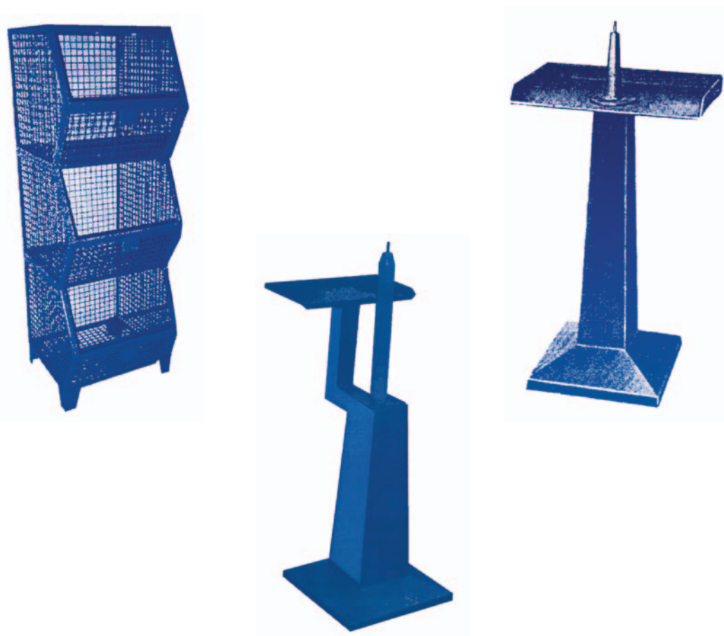
Figure 42 – Exemple d'étagère pour formes à trois niveaux superposés, à gauche; goujon porte forme sur petite colonne pour botte et pour chaussure normale, à droite.
