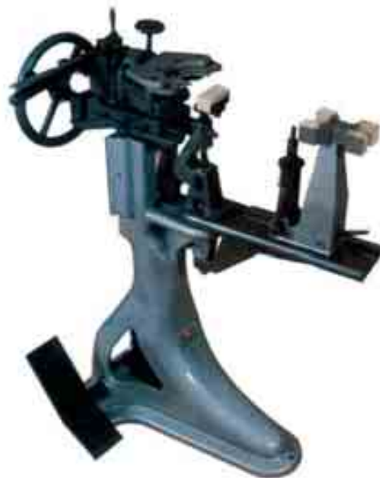
Figura 45. Ejemplo de máquina monta-puntas y monta-taloneras utilizada en estructuras artesanales.
