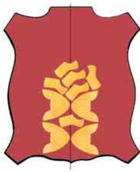
Figura 28- Esempio di disposizione corretta delle dime di un modello su una pelle.
