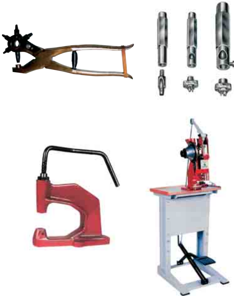
Figura 40 - Arriba: otras herramientas manuales de utilidad para realizar las uniones. Abajo: aparatos para la aplicación de piezas metálicas en general: completamente manual a la izquierda; de primera mecanización, a la derecha, con perforación del material y aplicación de la pieza en metal simultáneamente.
