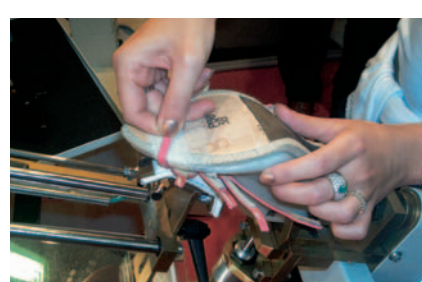
Figure 50 - Modalité séquentielle pour le montage d'une sandale de façon semi-automatique. Au centre système de blocage de la première à bras mécanique.
