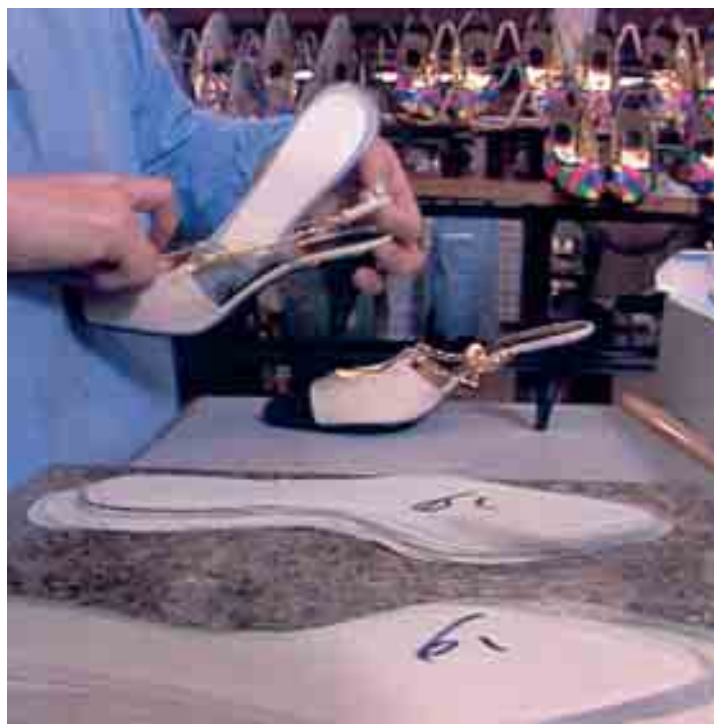
Figura 65 – Esempio di applicazione di tallonette di pulizia.
