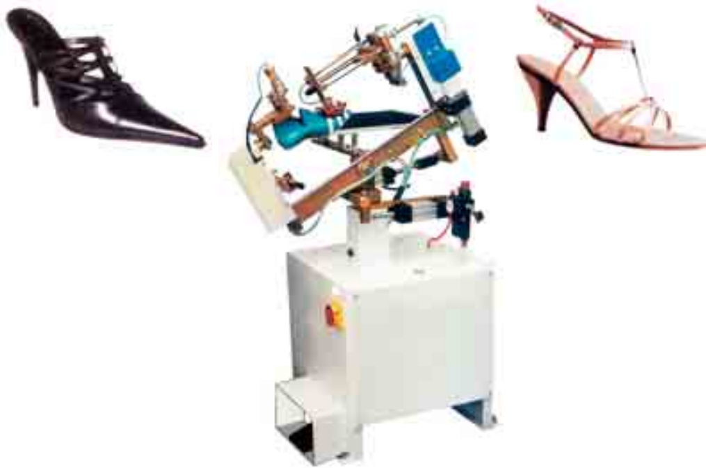
Figura 49 - Esempio di macchina di nuova generazione per il montaggio assistito di sandali e di calzature con tomaia aperta dietro.
