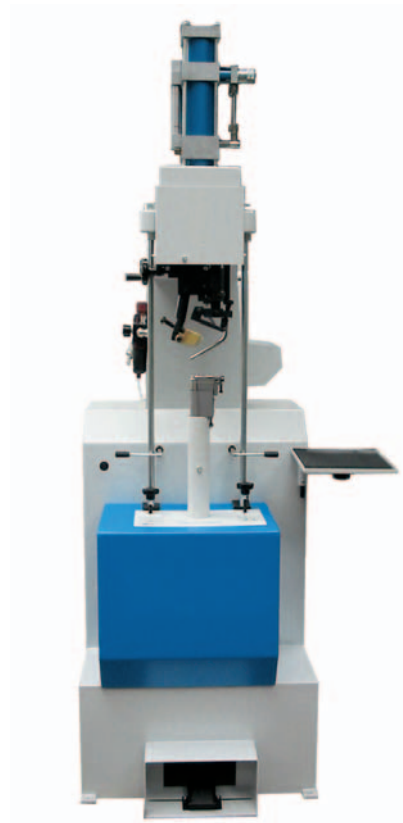
Figure 59 – Exemple de machine pour le clouage du talon et pour des interventions de tenue efficaces et à la fois délicats.
