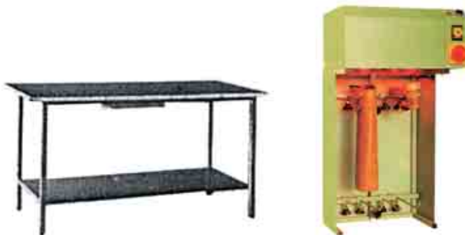
Figura 52 – Esempio di tavolo di lavoro per incollaggio del fondo della scarpa montata e della suola e fornello riattivatore colla.
