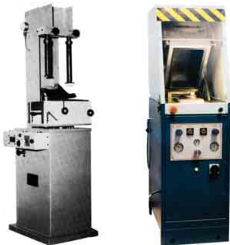
Figura 53 - Esempio di macchine pressasuole a una postazione di lavoro. A sinistra, versione oleodinamica con appoggio a settori; a destra, versione pneumatica tipo a membrana adatta anche per le suole a scatola.
