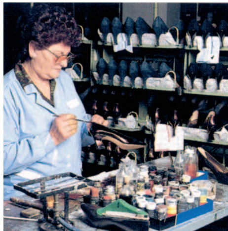
Figure 66 – Exemple d'une station cosmétique pour la chaussure.
