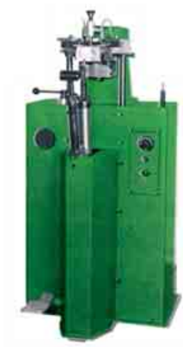
Figura 48. Esempio di macchina montaboetta con azionamento ad aria.
