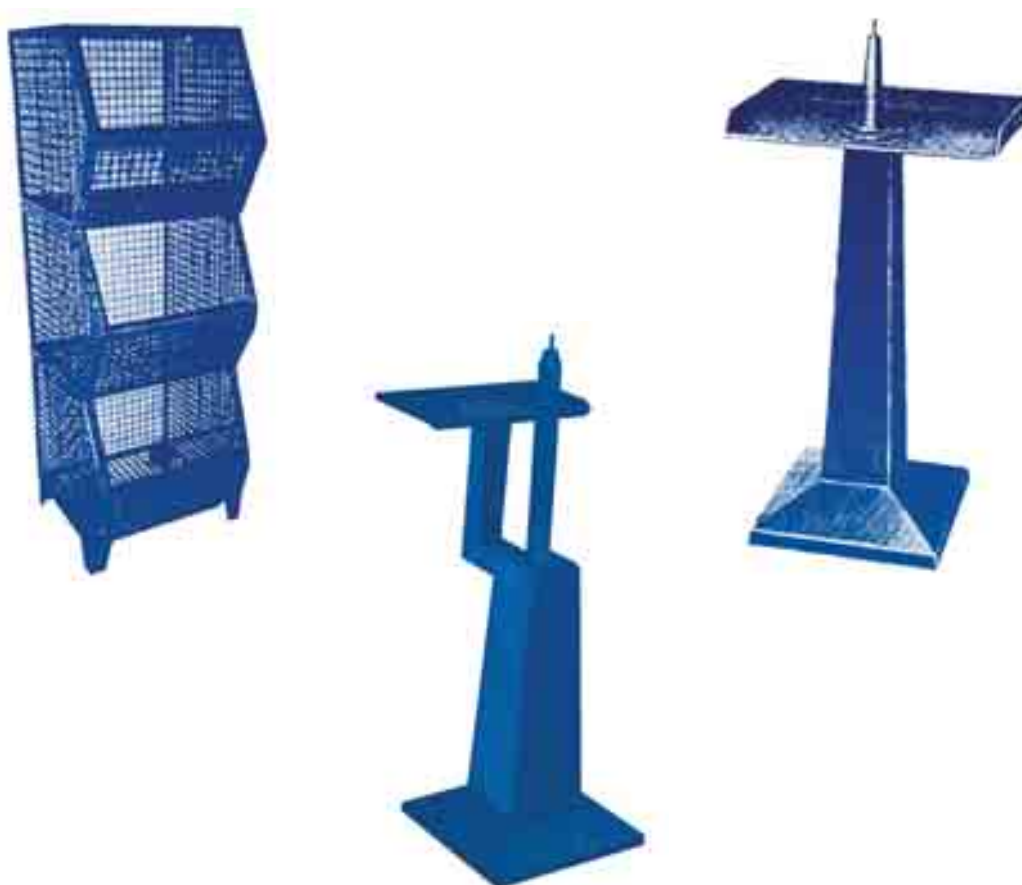
Figura 42 - Ejemplo de portahormas con tres contenedores sobrepuestos, a la izquierda; puntas en columna para botas, en el centro y para zapato normal, a la derecha.
