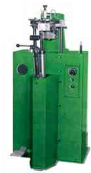
Figura 48. Ejemplo de máquina monta-talonera con accionamiento por aire comprimido.
