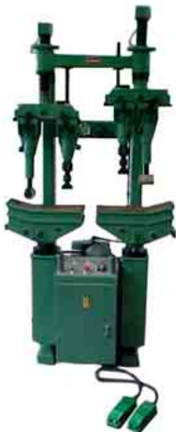
Figura 55. Pressasuole idraulica con due postazioni: una con settori lamellari per calzature con tacco alto, l'altra con vaschetta ad acqua.
