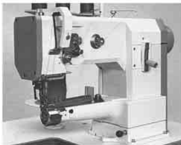
Figura 39 – Esempio di macchina con base a braccio equipaggiata per interventi di bordatura.
