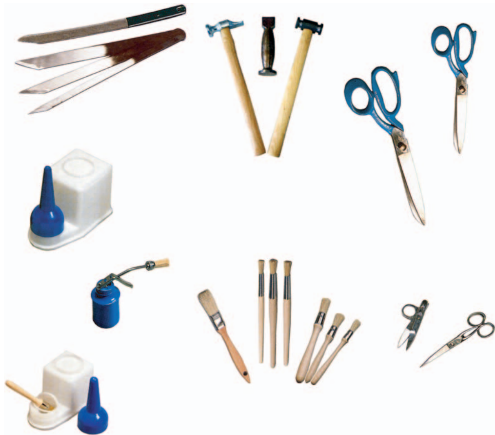
Figure 33 – Série d'outils manuels utilisés pour déposer la colle de préparation au jointage.
